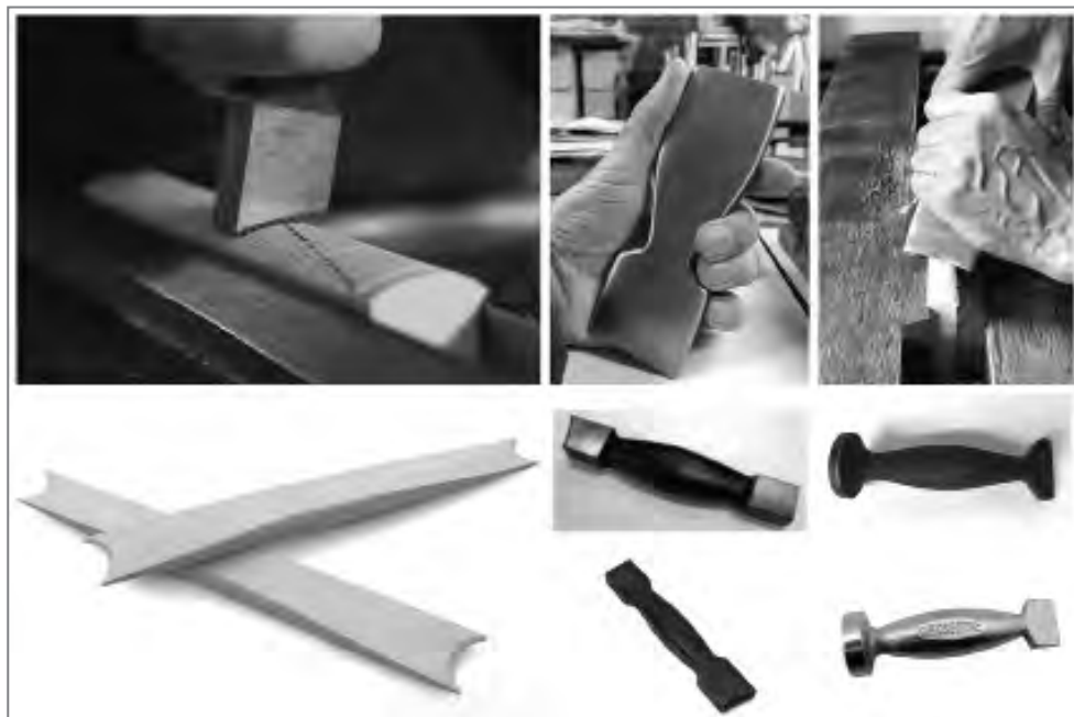
Фиг. 2. Исторически форми на инструмента Frottoir – Grattoir , изработени от метал и дърво, в последователност: датският Falsbanker на Carl Jensen, Kaschtoir на Джеф Пичей, дървеният Frottoir – Grattoir на американската компания Talas , немският Kaschiereisen , както и създаденият от компанията C.S. Osborne специализиран метален инструмент за работа с кожа
